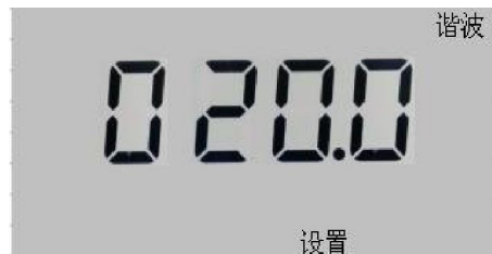
图 42 电压总谐波畸变率超限设置
