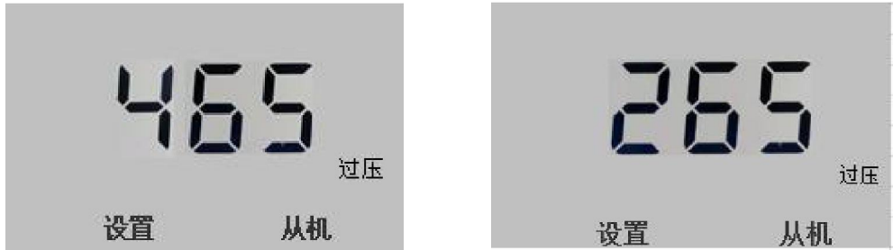
图 86 过压保护设置
