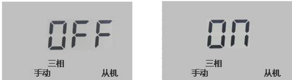
图 75 共补手动控制
