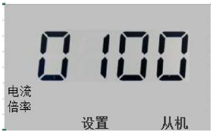
图 79 电流互感器变比设置
