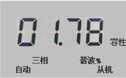
图 107 电压总谐波显示
