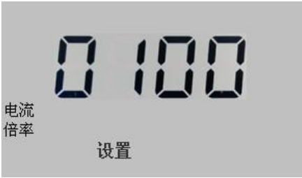
图 122 电流互感器变比设置
