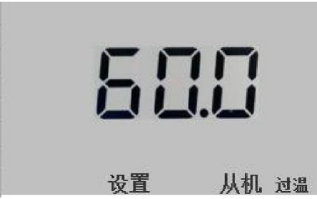
图 88 电压总谐波畸变率超限设置
