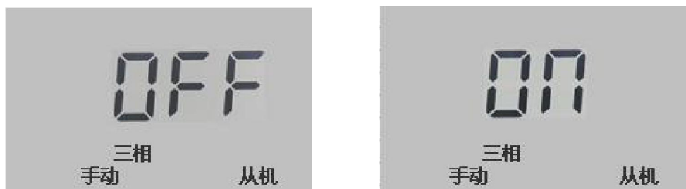
图 77 B 相手动控制
