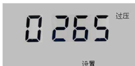
图 38 过压保护设置
