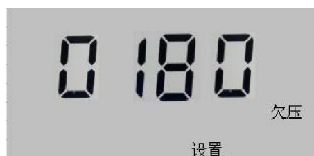
图 37 欠压保护设置
