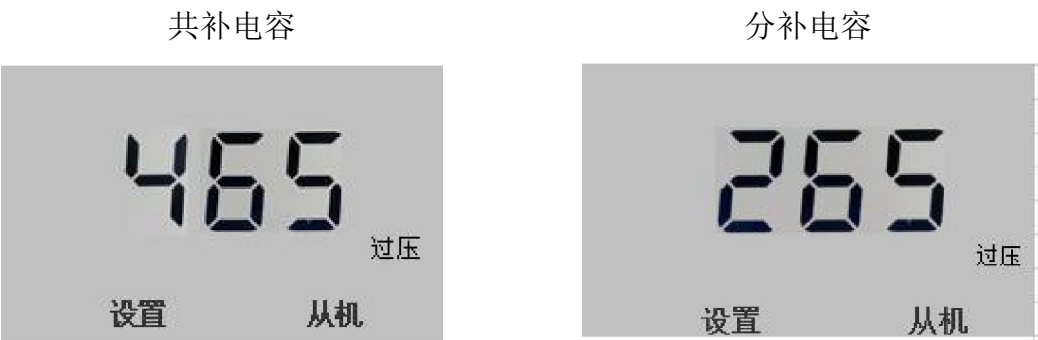
图 128 过压保护设置
