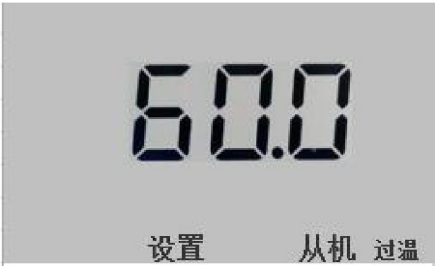
图 130 温度保护设置
