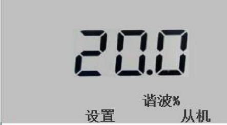
图 129 电压总谐波畸变率超限设置
