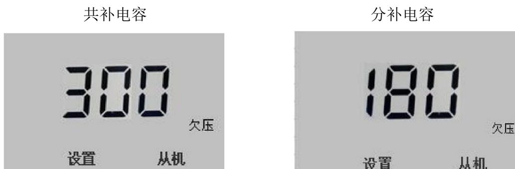
图 127 欠压保护设置
