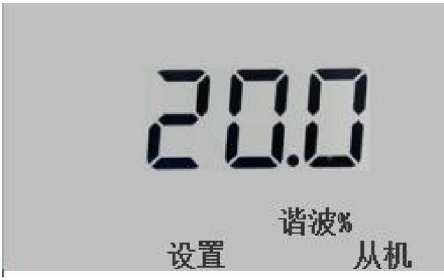
图 87 电压总谐波畸变超限设置
