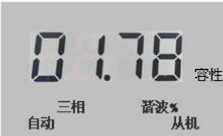
图 64 电压总谐波含量
