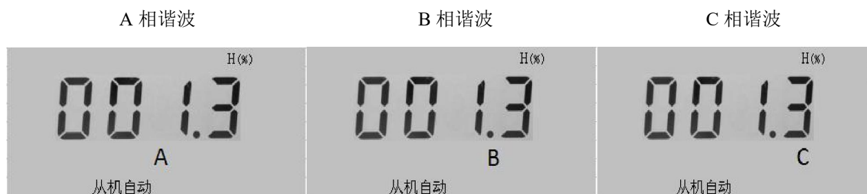
图 16 电压谐波含量
