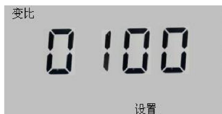
图 35 电流互感器变比
