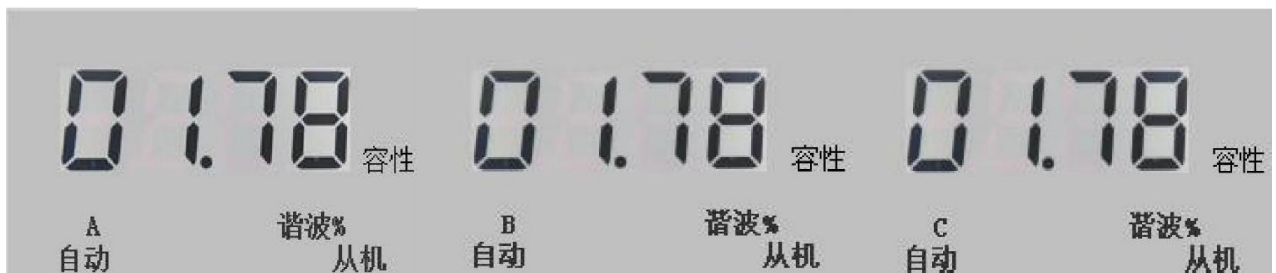
图 115 电压总谐波含量显示
